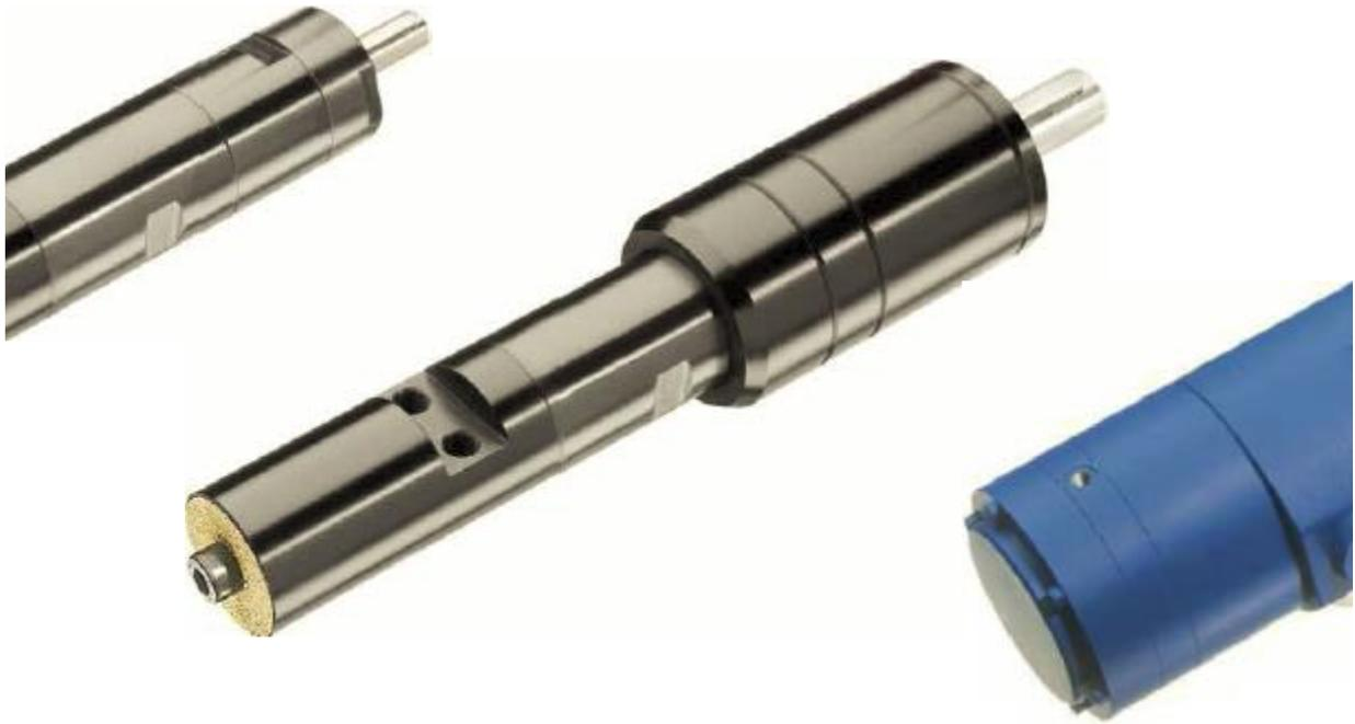
I motori MUB23 sono dotati di freno che tiene bloccato il motore quando non è alimentato. Non è necessaria una linea aria dedicata al freno, esso funziona in automatico, si sblocca quando il motore viene alimentato e si aziona quando viene interrotta l'alimentazione aria. La forza massima di frenatura è equivalente alla coppia di avviamento.
